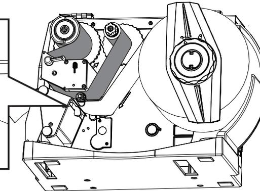
Ajuste a posição do sensor de etiquetas, deslizando a sua haste forma que o Led seja posicionado sobre o GAP ou Tarja Preta.
