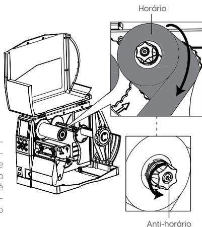
Com uma das mãos segure o botão preto do eixo que está próximo a parede da impressora, e com a outra vá girando o botão verde no sentido anti-horário, até travar. Certifique-se de que quando o ribbon é desenrolado, todo o eixo deve girar junto.
