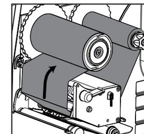
Passa o ribbon por baixo do eixo rebobinador e com um pedaço de fita adesiva, cole-o no eixo, de forma que seja enrolado no sentido anti-horário.
